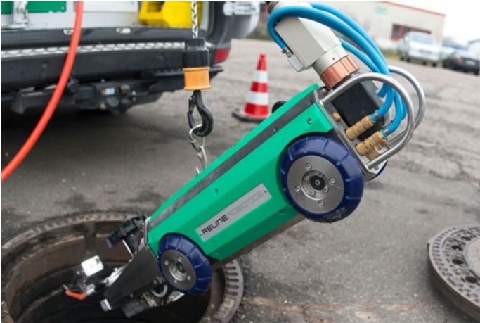
Gutes Handling durch anklappbaren Kabelstecker
