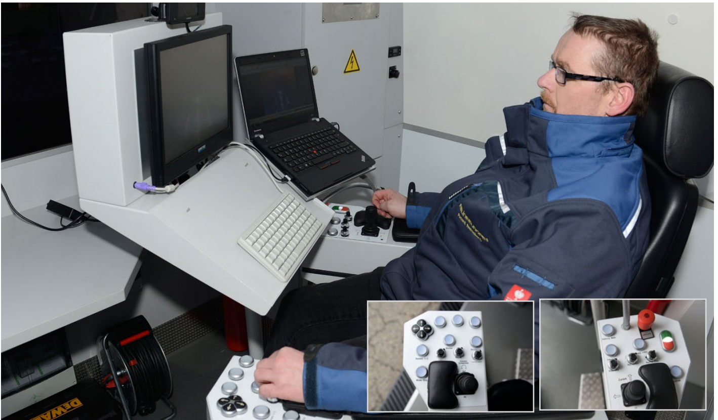
Ergonomisches Arbeiten mit Joystick im innovativen Steuerstand
