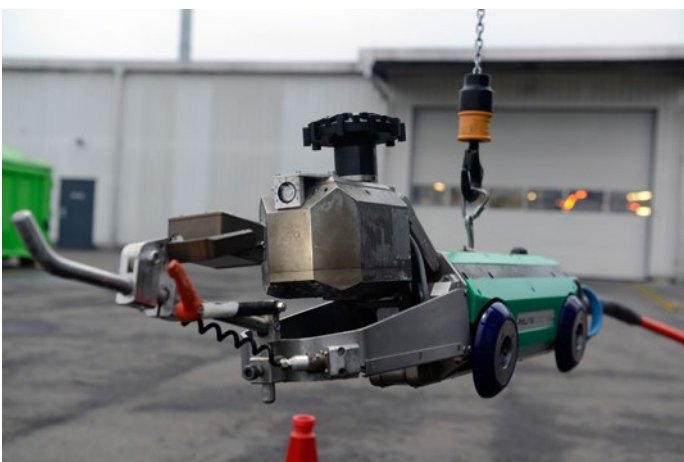
Fräskopf auf 160 mm ausfahrbar
